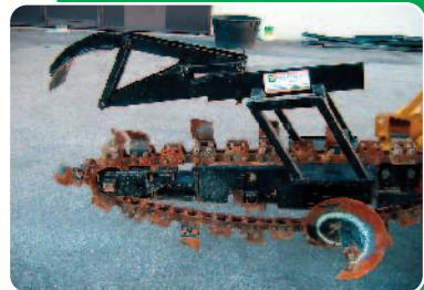
Attrezzo per l'esecuzione di trincee su materiale vegetale compatto. Il gruppo di scavo viene montato sul sollevatore con attacco a tre punti ed azionato dalla presa di forza a 540 giri/min di qualsiasi trattore da 60-120 cv in grado di consentire una velocità di circa 300 m/h con motore a regime.
